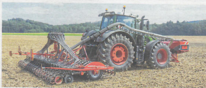
Die Taro 6 HD ist mit einem Reifenpacker und PowerDisc Säschen ausgestattet. | Foto: Horsch
